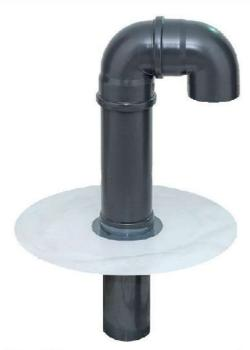
Die Rhedach Universaldurchführung, aus Hart PVC, wird mit einem runden Flansch und einem 300 mm langen oberen Rohr geliefert. Dazu sind 2 abnehmbare Bögen im Lieferumfang enthalten. Diverse Sondermaße und Trägermaterialien sind möglich. Erweiterbar durch eine EPDM Durchführungsmanschette die durch Abstufungen in DN 40, DN 50, DN 60 und DN 70 passend eingekürzt werden kann. Oder durch einen passenden Schrumpflauch ergänzt werden kann.
