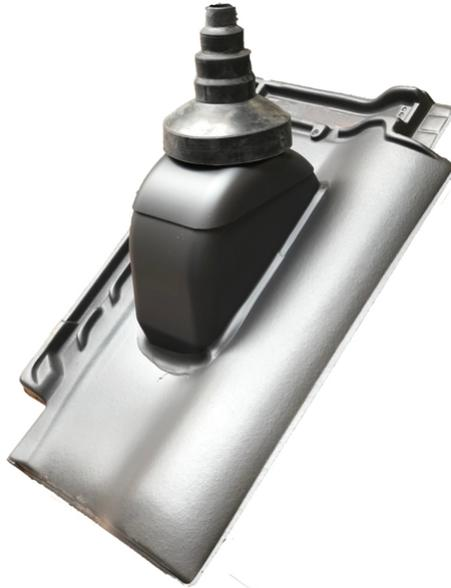
Der Rhedach Antennendurchgang universal ist zwischen 20° bis 50° stufenlos einstellbar und wird inkl. EPDM Manschette samt Edelstahlschelle geliefert. Der Antennendurchgang wird aus einem original Ziegel-/Betondachsteinmodell mit einem farblich abgestimmten Durchgang gefertigt.
